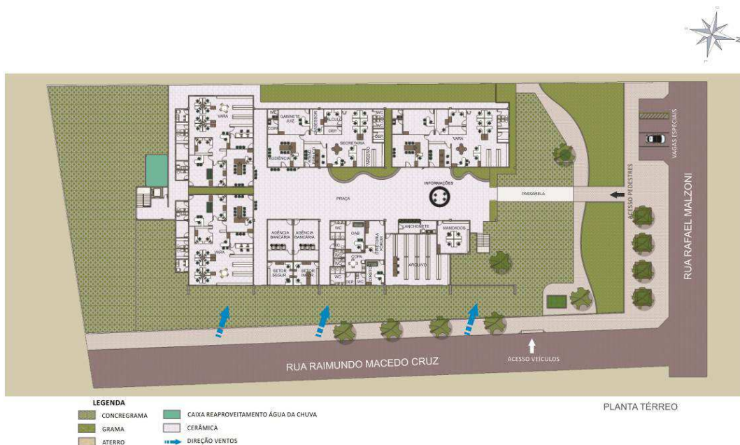
Figura 05 – Planta do Pavimento Térreo com 4 varas trabalhistas, acessibilidade PPNE, átrio não climatizado, que poderá ser usado para grandes eventos, área de 2.067,60m 2 .
