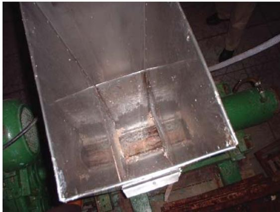
Figura 83 – Vista Superior do Triturador de Couros
