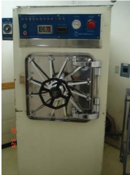
Figura 87 – Autoclave com óxido de etileno
