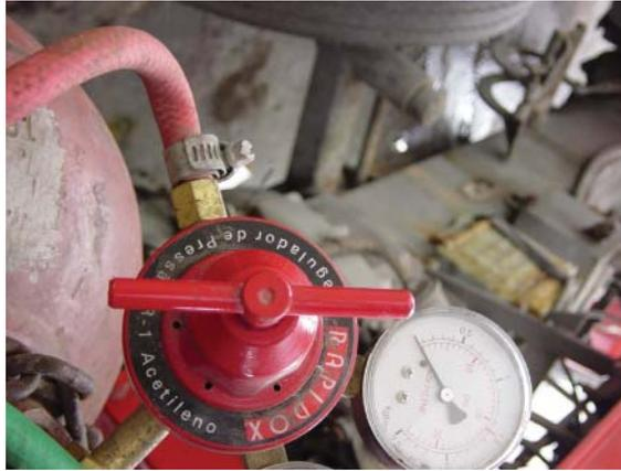
Figura 67 – Regulador de cilindro de acetileno
