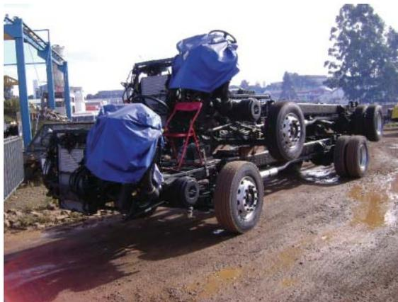
Figura 129 – Chassis destinados à montagem de ônibus
