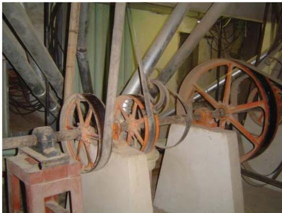
Figura 90 – Transmissão de Força Sem Proteção
