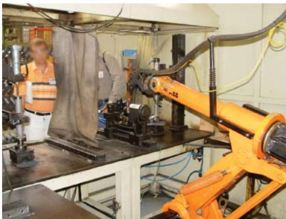
Figura 71 – Robô em operação em área com acesso não restrito
