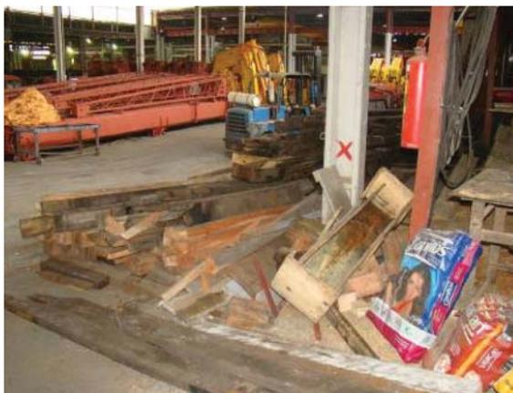
Figura 121 – Extintor de incêndio obstruído
