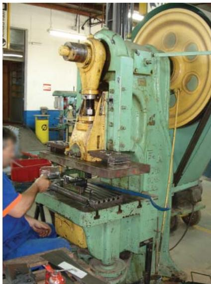
Figura 96 – Prensa mecânica excêntrica de engate por chaveta
