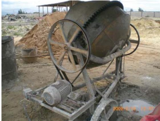
Figura 18 – Betoneira sem proteção
