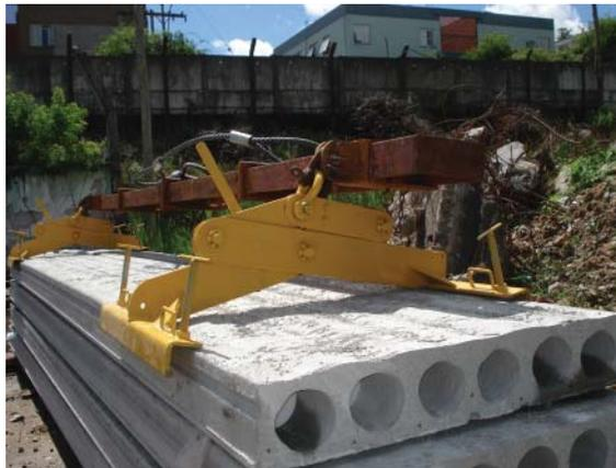
Figura 32 – Equipamento (garra) utilizado na montagem, movimentação e descarga de lajes pré-moldadas
