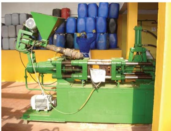
Figura 94 – Injetora sem Proteção
