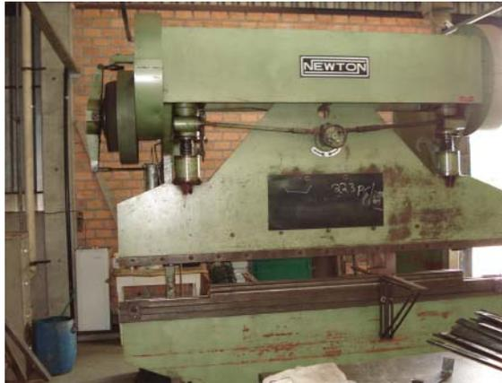
Figura 100 – Prensa dobradeira mecânica
