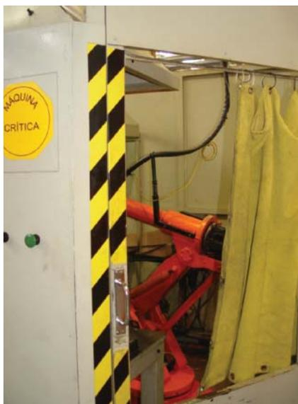
Figura 72 – Área de movimentação do robô não protegida
