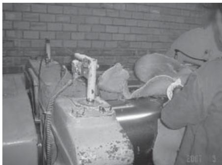
Figura 7 – O operador obriga-se a ingressar com mãos e braços nas proximidades da linha de potencial aprisionamento do equipamento. O dispositivo de proteção existente (linha de desengate) é totalmente ineficaz, pois permite o acesso livre à zona de risco e não garante a parada efetiva do equipamento em caso de acidente.
