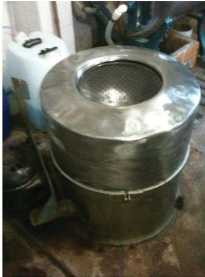
Figura 112 – Extratora de líquidos em têxteis (centrífuga)
