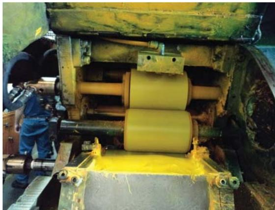
Figura 127 – Ausência de proteção de partes móveis e girantes
