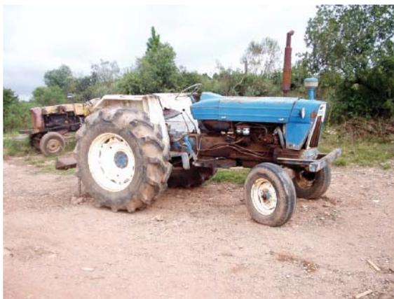
Figura 66 – Trator sem qualquer proteção
