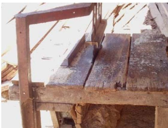
Figura 23 – Serra circular montada, palco de uma série de improvisações
